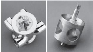
▲ウィルソンが生み出したロタックスバルブシステム。空気の流れを限りなくゼロに近づけ、ロータリーポートを構内することで理想に近い空気の流れが得られ、同時に小型軽量化によって素早いバルブアクションを実現した。
